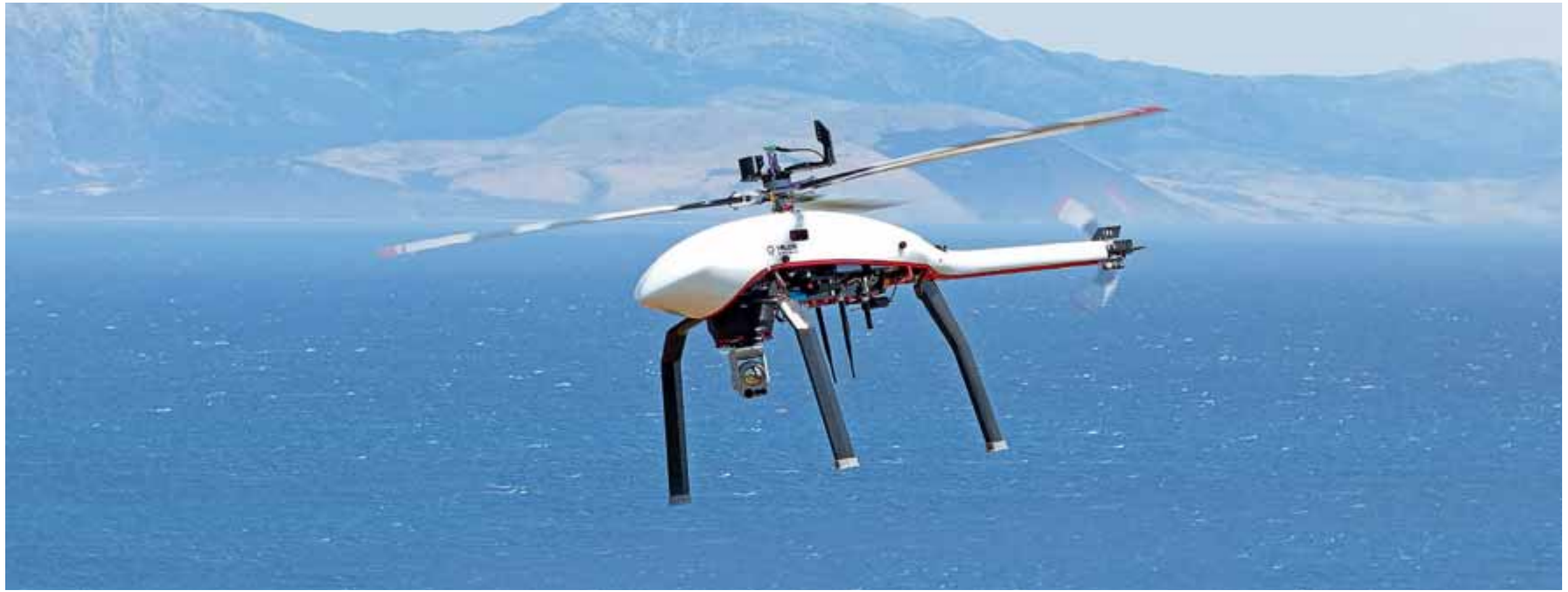
Η Velos Rotors τα τελευταία χρόνια σχεδιάζει και συναρμολογεί από το στρατηγείο της στο Ξυλόκαστρο ηλεκτρικά μη επανδρωμένα ελικόπτερα για διττή χρήση. Αυτά μεταφέρουν από ανθρώπινα όργανα για μεταδόσχευση μέχρι αισθητήρες lidar για τη χαρτογράφηση μιας περιοχής ή και μαγνητόμετρα ώστε να εντοπιστούν νάρκες.
