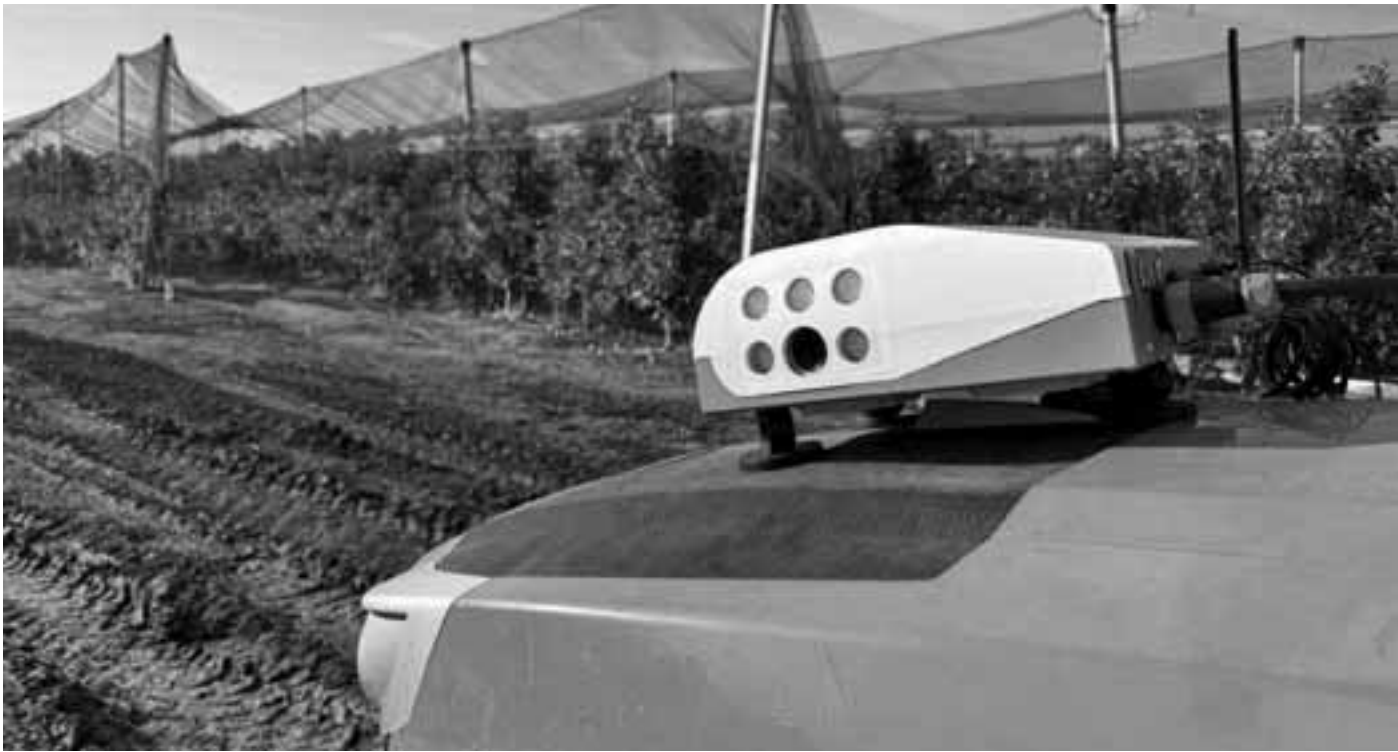
Το σύστημα Viewer της EdenCore τοποθετείται μπροστά στα τρακτέρ, εντοπίζει ασθένειες, βοηθάει στην επιλογή ποσότητας φυτοφαρμάκων και κάνει εκτίμηση της δυνατότητας παραγωγής των καλλιεργειών.
