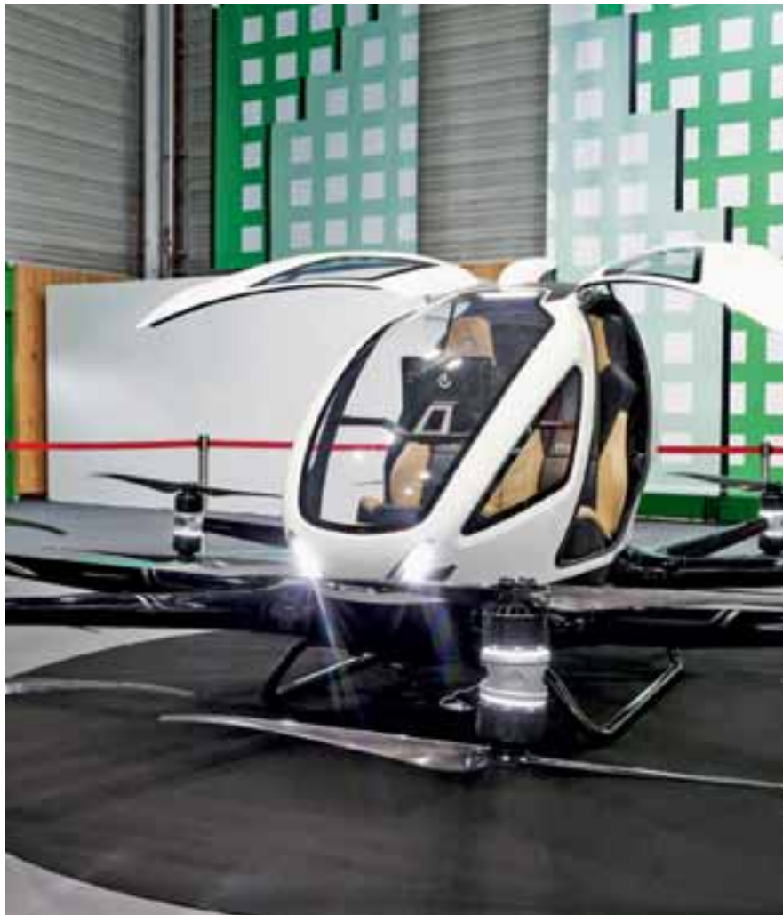
Το ηλεκτροκίνητο αεροταξί της EHang κοστίζει 300.000 δολ., έχει έξι βραχίονες που βγαίνουν από το κέντρο του, είναι εξοπλισμένο με 16 προπέλες, καθέμία από τις οποίες έχει δικό της ηλεκτροκίνητο κινητήρα και κινείται με ταχύτητα περίπου 100 χλμ. την ώρα επί 25 λεπτά.
