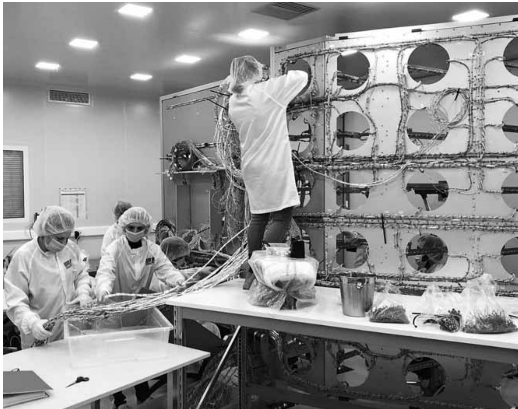
Επιστήμονες της ελληνικής ELFON κατασκευάζουν τον εξοπλισμό (ύψους 3 μ. και μήκους 4,5 μ.) με την απαραίτητη καλωδίωση του διαστημικού τηλεσκοπίου Plato, που θα εγκατασταθεί στο Διάστημα.
