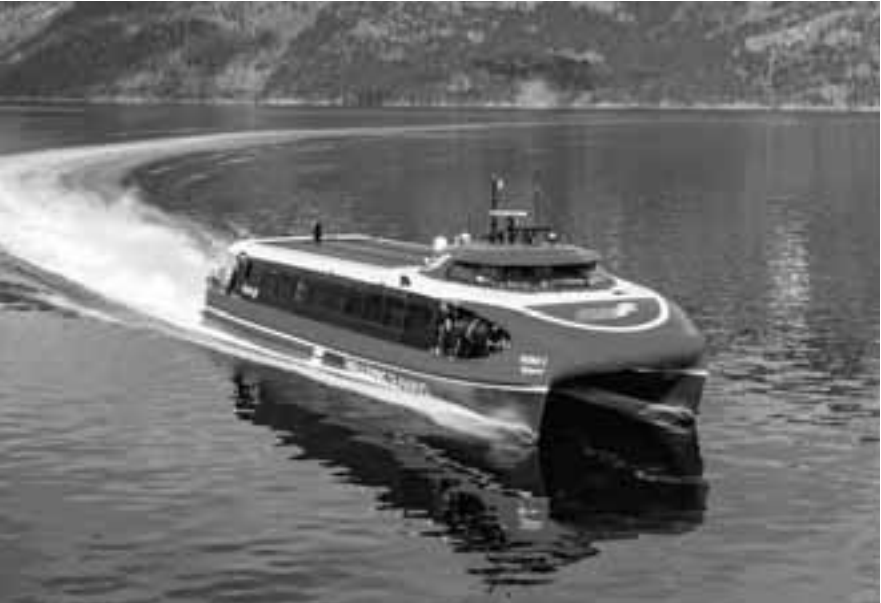
Τα ταχύπλοα καταμαράν Aero είναι ντιζελοκίνητα και έχουν κατασκευαστεί από ανθρακονήματα. Η ηλεκτροδότηση της καμπίνας εξασφαλίζεται από φωτοβολταϊκά πάνελ. Η μέγιστη ταχύτητά τους είναι 32,2 κόμβοι με πλήρες φορτίο.
