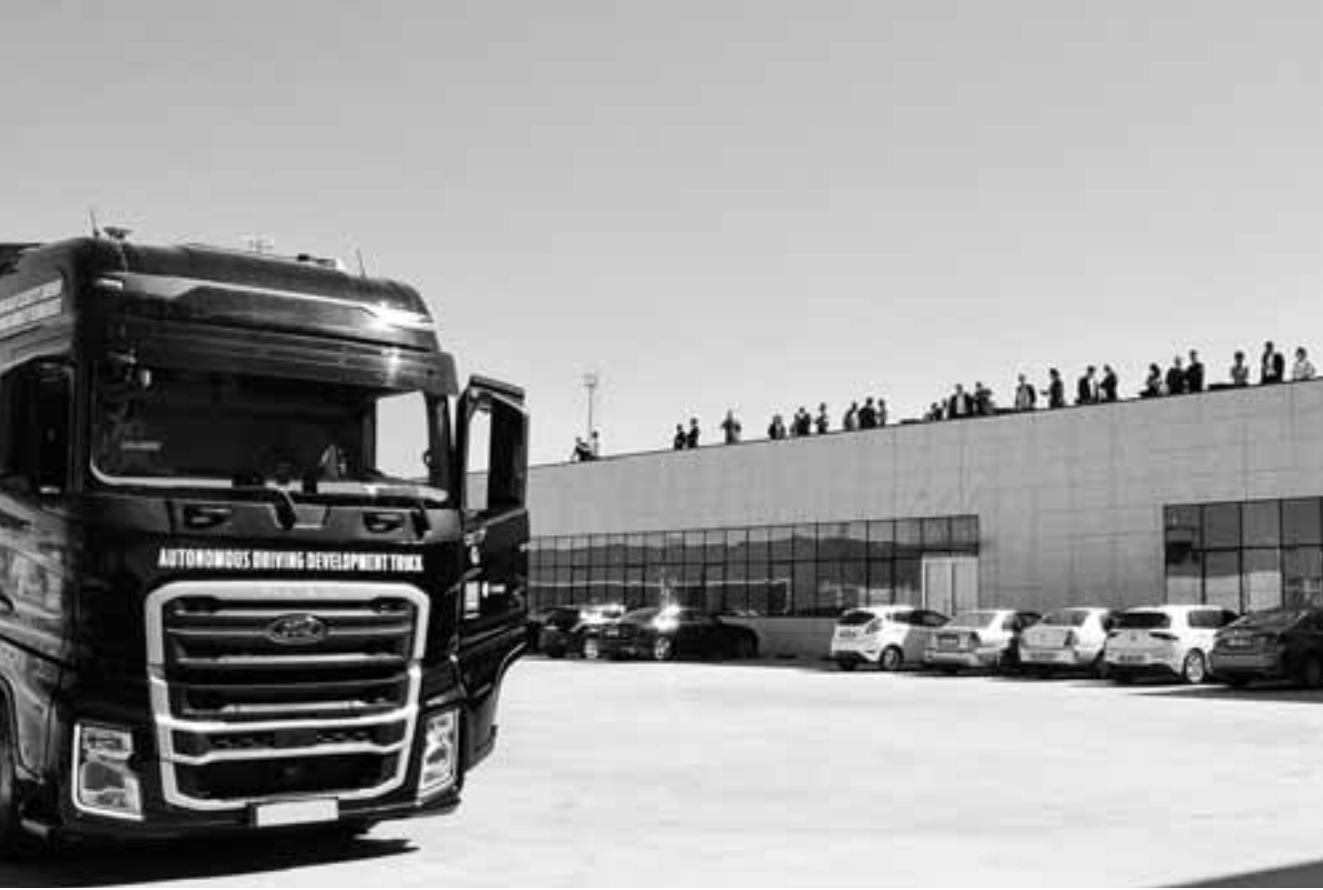
Στη δοκιμή στα ελληνοτουρκικά σύνορα χρησιμοποιήθηκαν δύο φορτηγά, από τα οποία στο ένα μόνο υπήρχε οδηγός. Στα δύο φορτηγά που χρησιμοποιήθηκαν στις δοκιμές του Εβρου τοποθετήθηκαν αισθητήρες, κάμερες, ραντάρ και ειδικό σύστημα, ώστε να είναι δυνατή η ανταλλαγή πληροφοριών μεταξύ τους.
