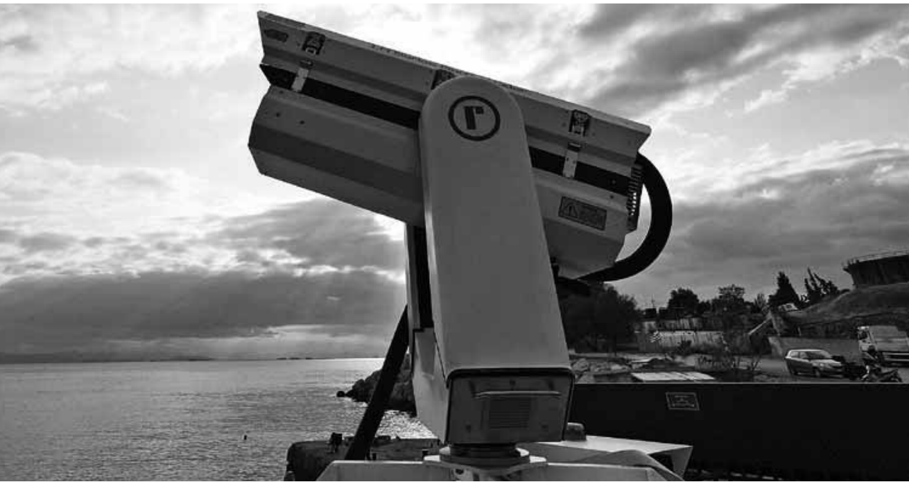
Οι αισθητήρες έχουν βάρος 200-250 κιλών, μήκος περίπου 1,20 μ. και κατασκευάζονται στη μονάδα της Raymetrics στη Μεταμόρφωση.
