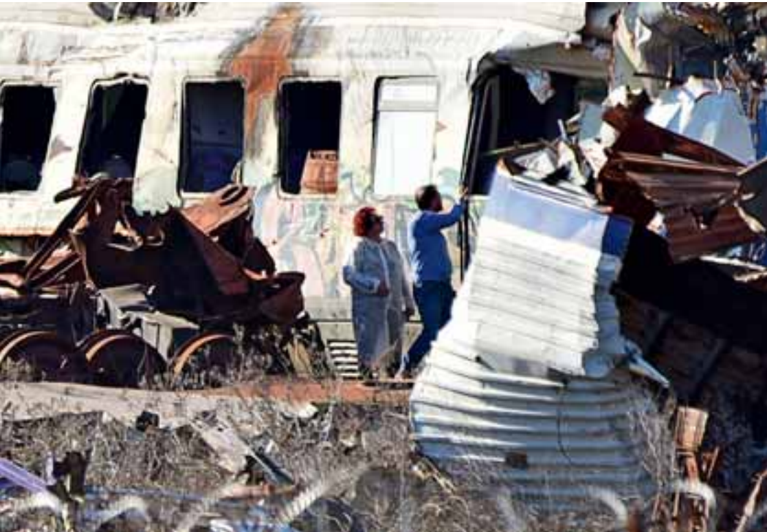
Το πόρισμα του καθηγητή του ΕΜΠ Πέτρου Τσακριδιδά αναφέρει ότι «τα κομμάτια του πιλοτηρίου και τα πλαίσια της ηλεκτρομηχανής που εξετάστηκαν δεν είναι καμένα, δεν δηλώνουν δηλαδή έκρηξη, αλλά φέρουν μόνον παραμορφώσεις από κτυπήματα που προκλήθηκαν από τη σύγκρουση των τρένων».
