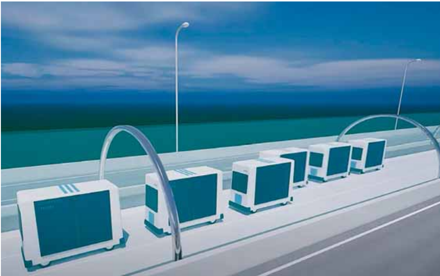
Σύμφωνα με βίντεο με ηλεκτρονικά γραφικά που κυκλοφόρησε από την ιαπωνική κυβέρνηση, ο δρόμος αυτόματης ροής θα βρίσκεται στη μέση ενός αυτοκινητόδρομου, με τα οχήματα σε αντίθετες κατευθύνσεις στην κάθε πλευρά.
