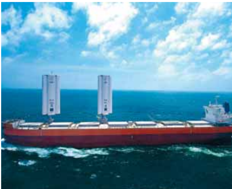
Τα ιστία που τοποθετήθηκαν στο «Pyxis Ocean» της Mitsubishi Corporation ανυψώνονται μόνο όταν το πλοίο βρίσκεται εκτός λιμανιού, ενώ είναι κατασκευασμένα από το ίδιο υλικό με τις ανεμογεννήτριες, ώστε να είναι ανθεκτικά.
