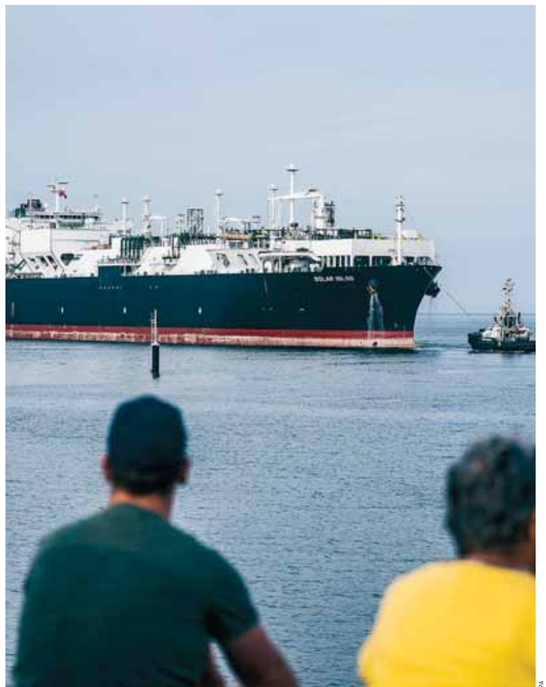
Εξω από το λιμάνι Εεμσχάβεν της Ολλανδίας βρίσκονται δύο πλωτοί τερματικοί σταθμοί, οι Golar Igloo και Eemshaven LNG, που έχουν τον εξοπλισμό της επανεξαέρωσης του καυσίμου.
