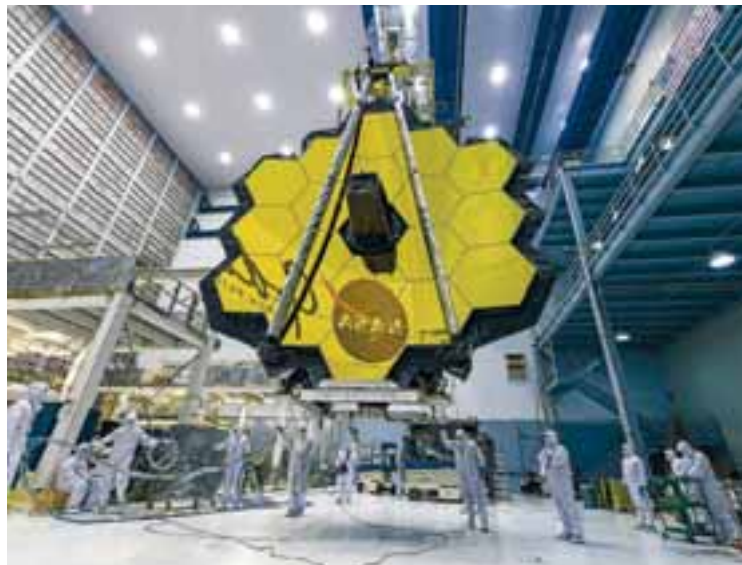
Τεχνικοί της NASA σπκώνουν τον μεγάλο καθρέφτη του τηλεσκοπίου χρησιμοποιώντας έναν ειδικό γερανό στο Goddard Space Flight Center.
