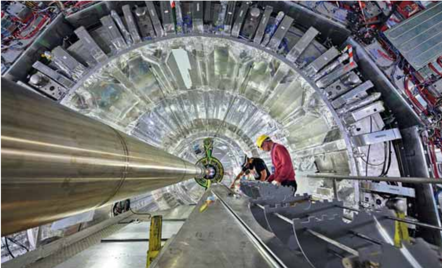
Ο επιταχυντής θα λειτουργήσει έως το 2025. Στη συνέχεια, επί μία διετία, θα υποστεί αναβαθμίσεις. Στις πρόσφατες αλλαγές συγκαταλέγεται η αναβάθμιση των πελώριων ανιχνευτών που βρίσκονται στα τέσσερα σημεία διασταύρωσης, όπου συγκρούονται οι δέσμες πρωτονίων.
