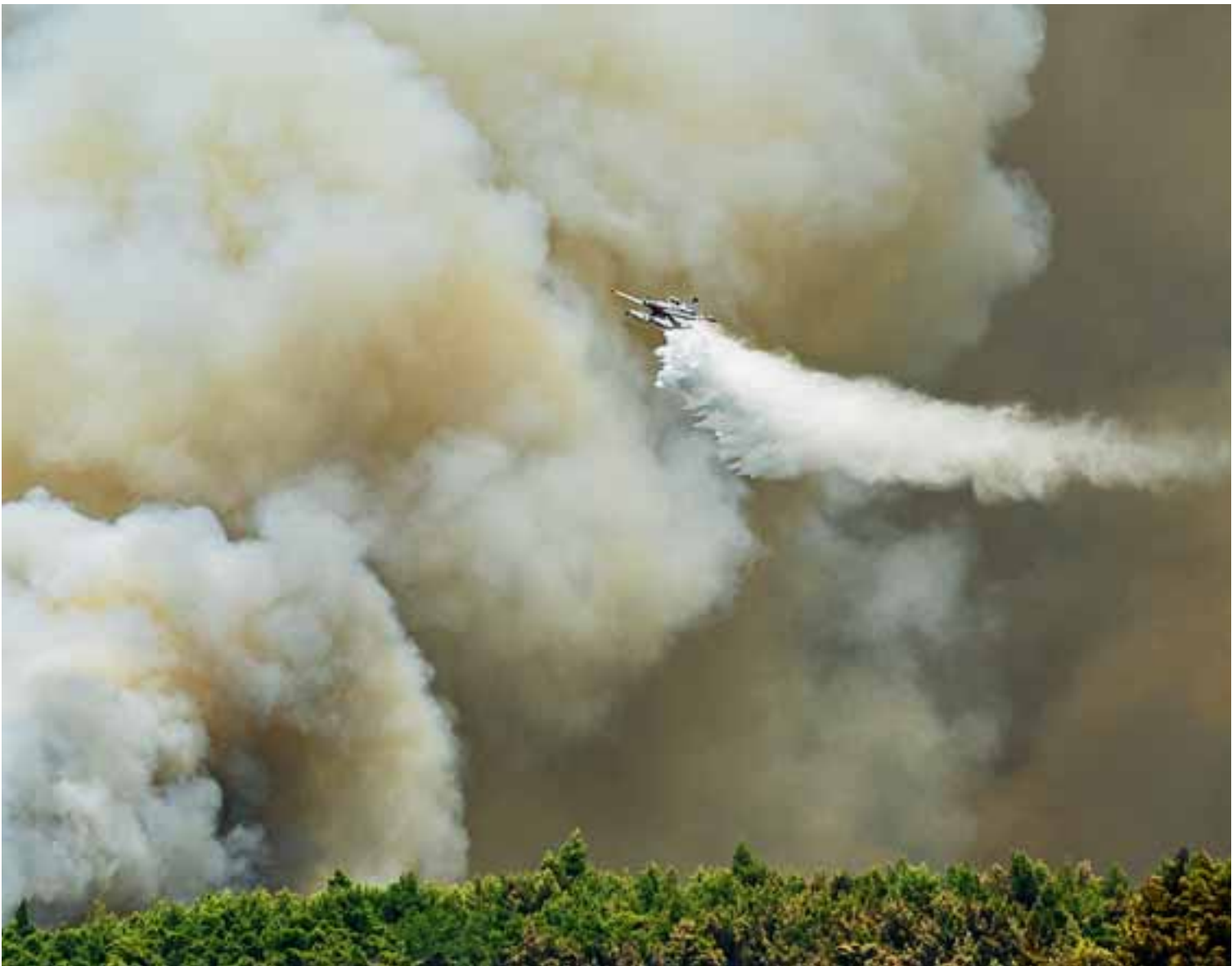
Η εναέρια επιτήρηση των δασών κατά τις ημέρες υψηλής επικινδυνότητας θα γίνεται με AirTractors (φωτ.). Πρόκειται για μικρά αεροσκάφη που μισθώνει το πυροσβεστικό σώμα, τα οποία πετούν έμφορτα με τρεις τόνους νερού, είναι ευέλικτα και αξιολογούνται ιδανικά για τη λεγόμενη πρώτη προσβολή.
