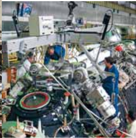
Εγκατάσταση ρομποτικού βραχίονα, που κατασκευάστηκε στην Ευρώπη, στο ρωσικό εργαστήριο πολλαπλών χρήσεων Nauka.
