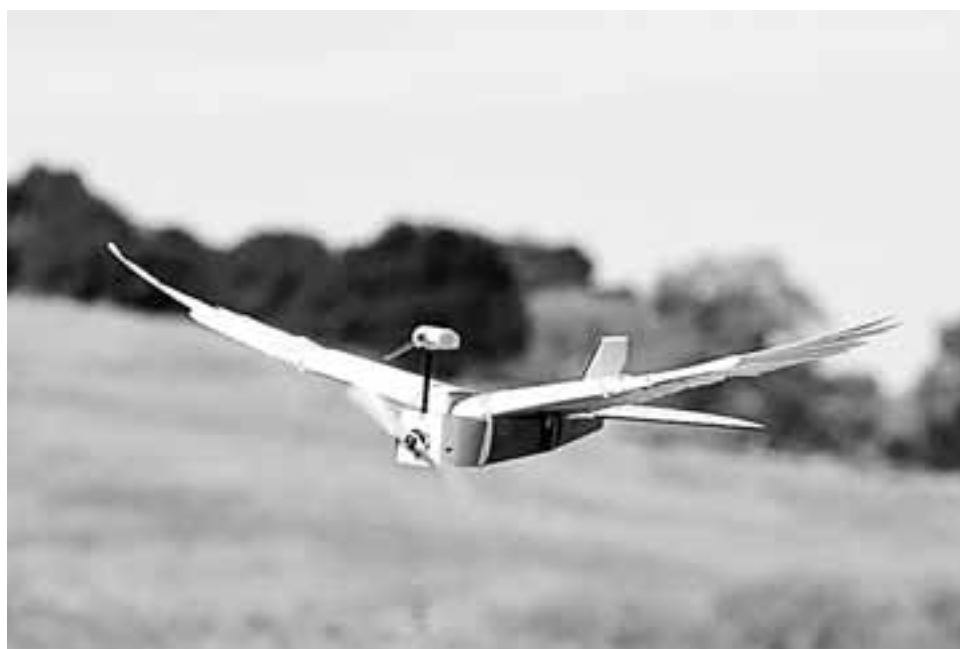
Το φουτουριστικό PigeonBot αποτελείται από ρομποτικό σώμα και πραγματικά φτερά περιστεριού.
