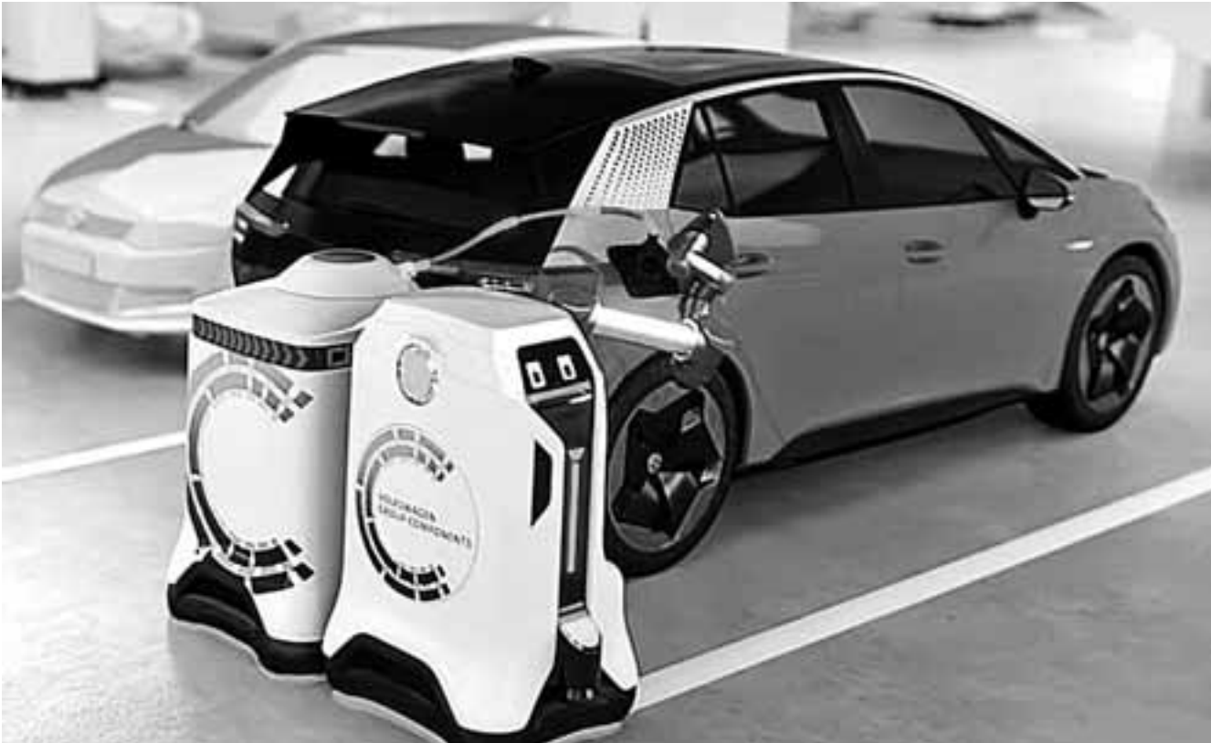
Το ρομπότ φόρτισης προτείνεται ως εναλλακτική στην αναζήτηση των δυσεύρετων σταθμών. Είναι εξοπλισμένο με κάμερες, σαρωτές λέιζερ και αισθητήρες υπερήχων και μπορεί να κυκλοφορεί ακόμα και σε στριμωγμένους χώρους.
