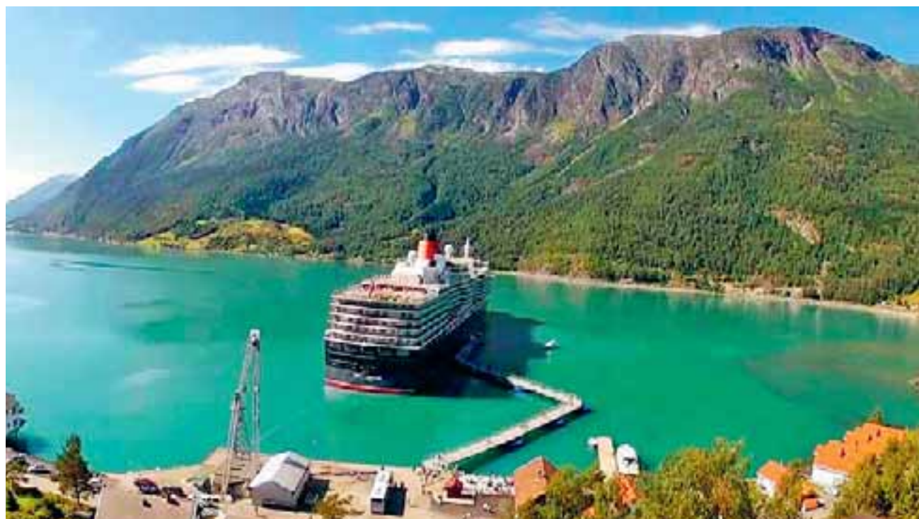
Το SeaWalk είναι τηλεκατευθυνόμενο, εύκολα μετακινούμενο και επιτρέπει πολύ ταχύτερη αποβίβαση των επιβατών.
