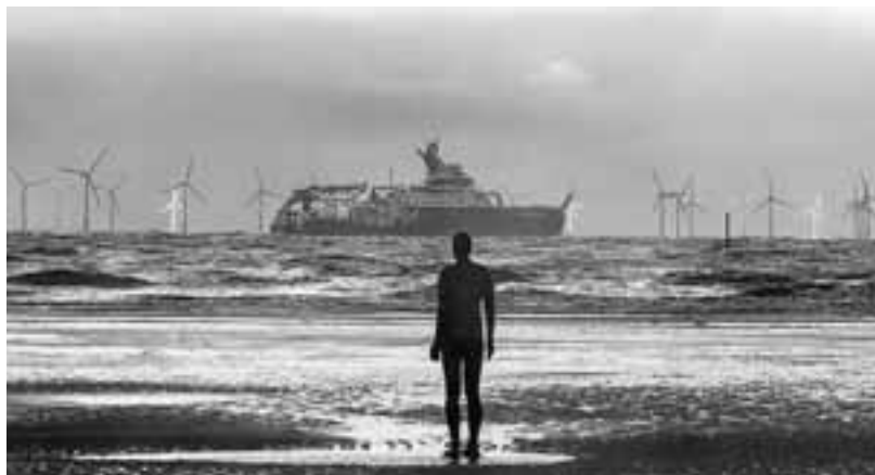
Το «Σερ Ντέιβιντ Ατένμπορο» είναι κατασκευασμένο έτσι ώστε να ταξιδεύει σε πάγο πάχους ενός μέτρου με ταχύτητα 3 κόμβων.
