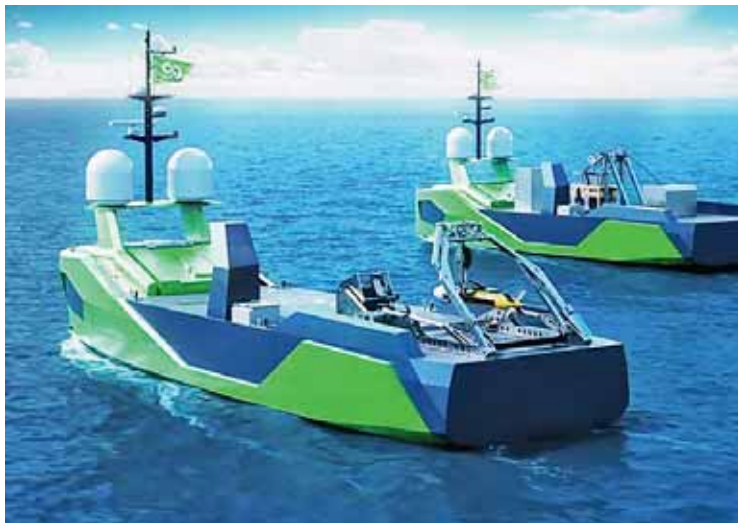
Ψηφιακή αναπαράσταση των μη επανδρωμένων σκαφών επιφανείας (USV), τα οποία η εταιρεία Ocean Infinity πρότεινε να αναλάβουν το εγχείρημα.
