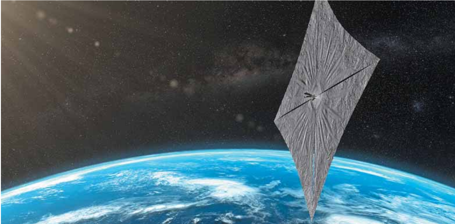
Το «LightSail-2», τα ασημένια ιστία του οποίου έχουν συνολικό εμβαδόν 31,95 τ.μ. Το κυρίως σκάφος έχει μέγεθος... φραντζόλας ψωμιού.
