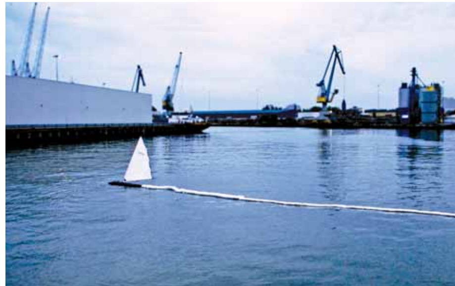
Μία από τις εκδοχές του ιστιοφόρου σκάφους Protei, το οποίο σχεδιάστηκε για τη συλλογή πετρελαίου από τη θάλασσα, σε δοκιμαστική πλεύση στο λιμάνι του Ρότερνταμ της Ολλανδίας.
