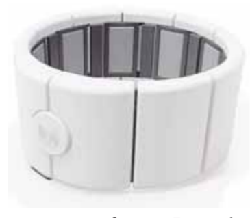
Ο ενσωματωμένος επεξεργαστής του MYO θα αναλύει στα δεδομένα από την κίνηση του χεριού και θα τα στέλνει ασύρματα στον υπολογιστή.
