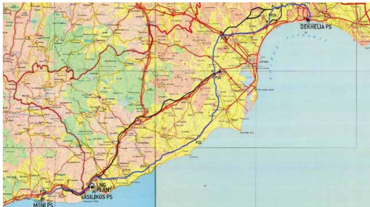
Αύο ήταν οι βασικές διαδρομές που εξετάστηκαν, όπως φαίνεται κι από τον χάρτη, για διοχέτευση του αερίου στους ηλεκτροπαραγωγούς σταθμούς. Η μαύρη γραμμή βρίσκεται δίπλα από τον αυτοκινητόδρομο και η δεύτερη (η μπλε) ακολουθεί τον Νότιο Αγωγό. Ο αγωγός φυσικού αερίου αποτελεί μία αναγκαία υποδομή για την ανάπτυξη της αγοράς φυσικού αερίου και είναι η ραχοκοκαλιά του μελλοντικού συστήματος που θα φτάνει στα σπίτια.
