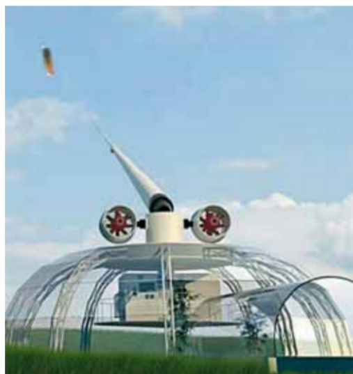
Το ιπτάμενο τμήμα της ανεμογεννήτριας αποτελείται από ύφασμα και ο υπόλοιπος μηχανολογικός εξοπλισμός βρίσκεται στη βάση της μονάδας.
