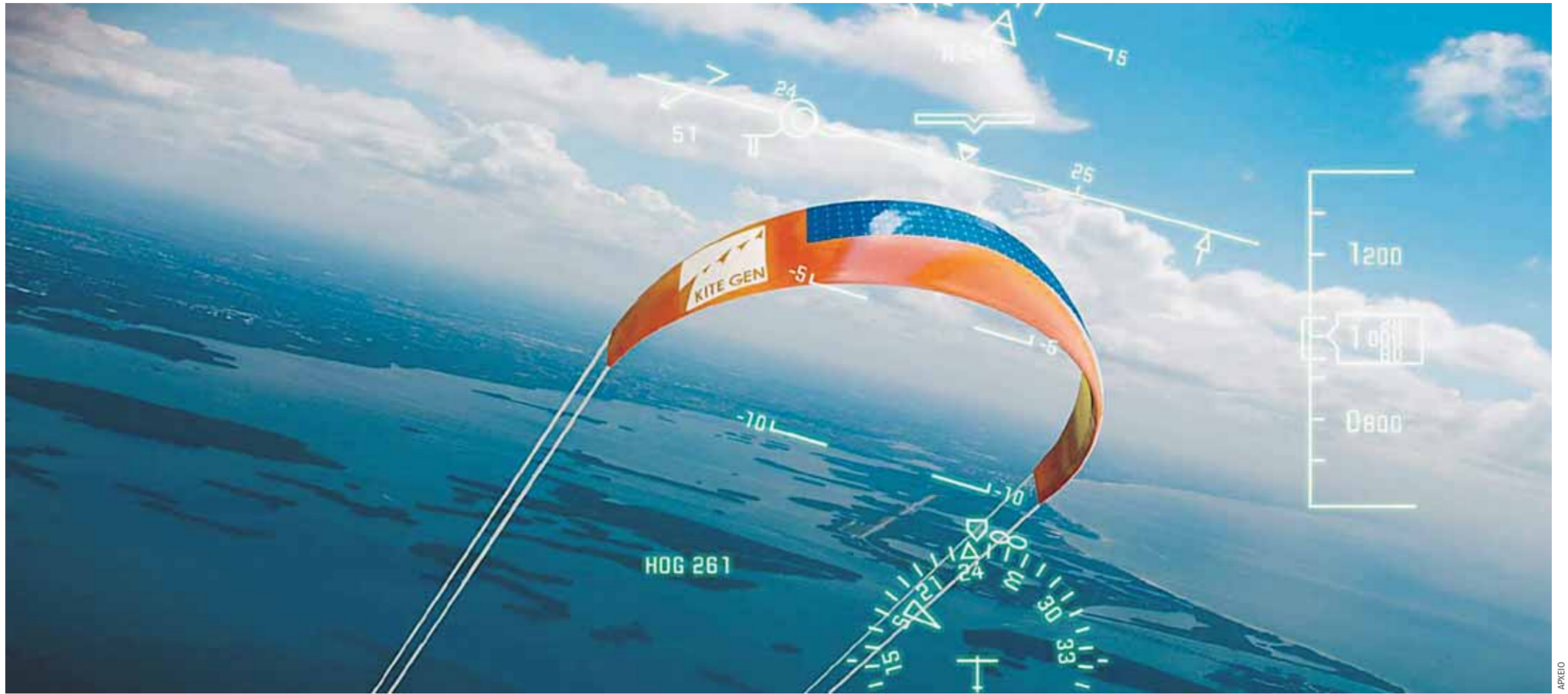
Αυτόματος πιλότος αναλαμβάνει τους ελιγμούς που πρέπει να πραγματοποιήσει η υφασμάτινη κατασκευή για να πάρει την κατάλληλη θέση σε σχέση με τη φορά των ανέμων.
