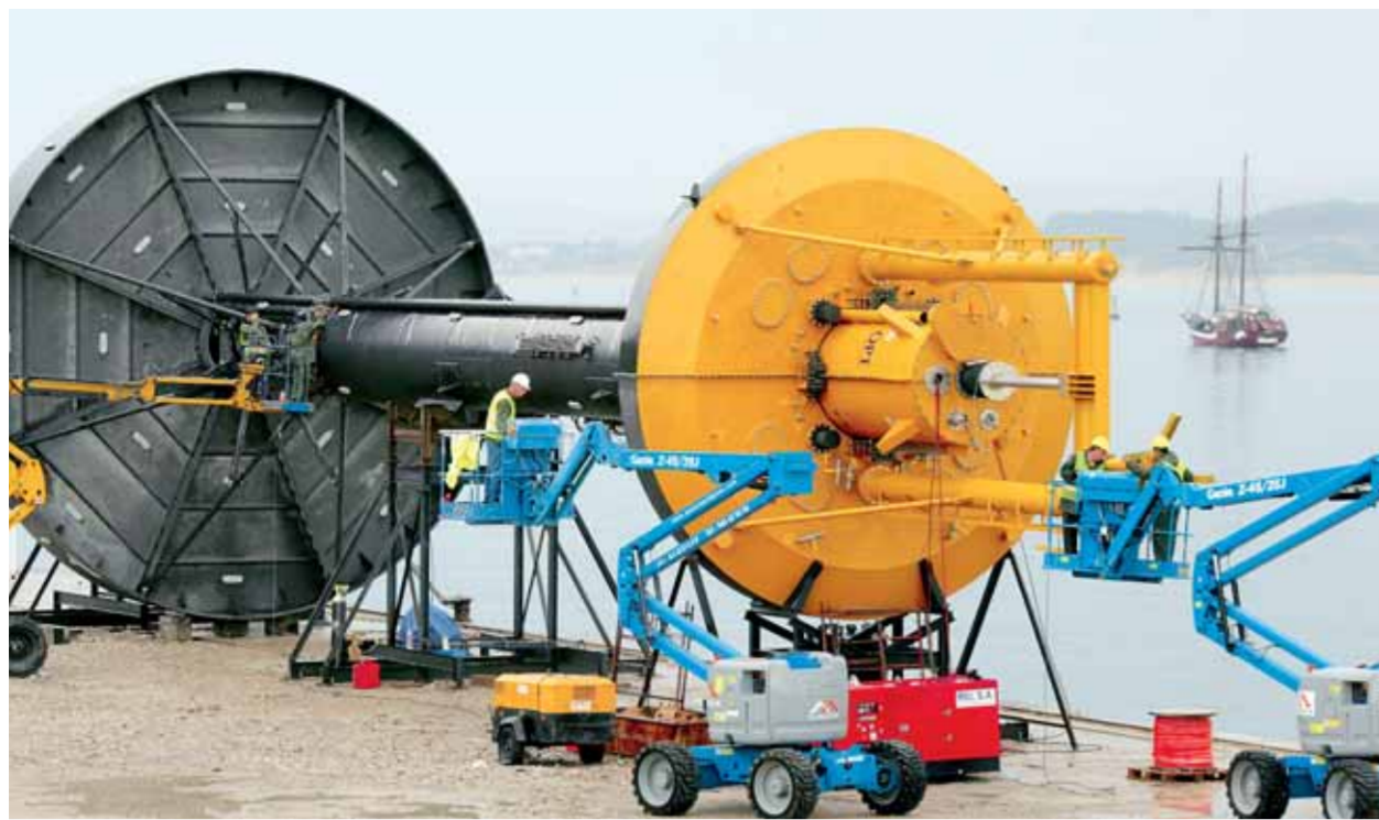
Κάθε μονάδα Powerbuoy είναι θεοράτη. Έχει διάμετρο 3,5 και ύψος 15 μέτρα. Μόλις τα τέσσερα μέτρα από την κορυφή της παραμένουν έξω από το νερό, καθώς τα περισσότερα από τα μηχανικά και ηλεκτρονικά τμήματα βρίσκονται βυθισμένα στη θάλασσα.
